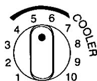
Para una habitación que está muy caliente, ajuste la perilla del control en la dirección de las manecillas del reloj.
