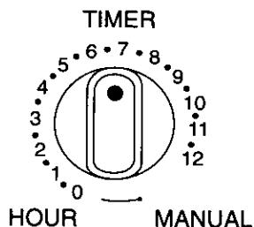
Cuando gire la perilla del Control del Temporizador hacia el ajuste MANUAL, el acondicionador de aire comenzara a funcionar y operará de forma continua siempre que la perilla del Control Principal se encuentre en cualquier posición, menos en la de OFF.
